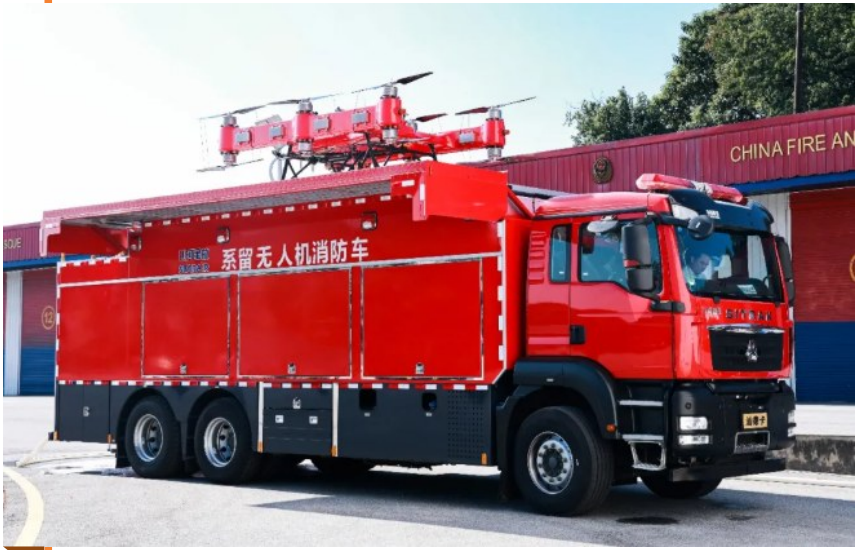
山河星航大载重高层建筑消防系留无人机交付装备。受访者供图
