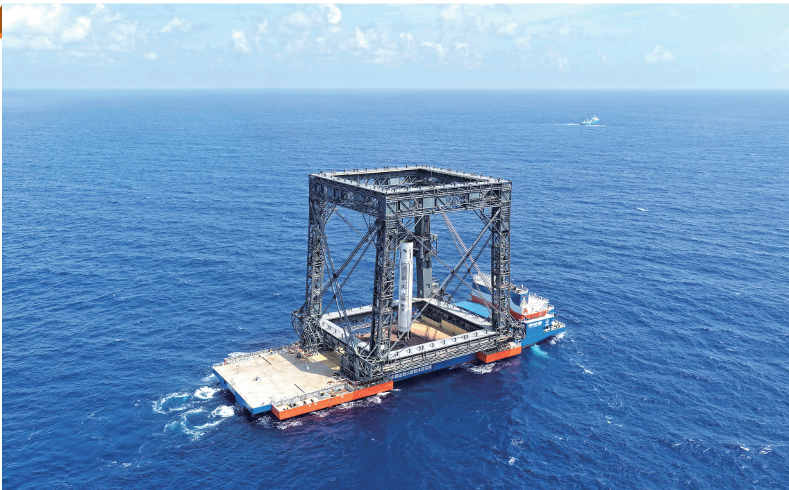
这是海上回收平台通过网系捕获方式成功回收长征十号乙运载火箭一子级(7月10日摄,无人机照片)。 新华社记者 邢广利 摄
