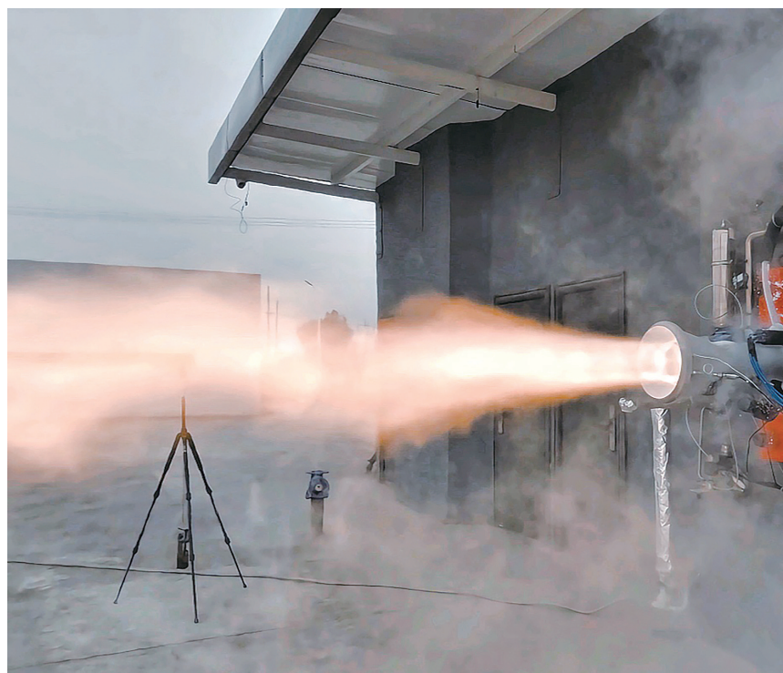
“焯天”发动机成功完成20%低工况全系统热试车。企业供图
