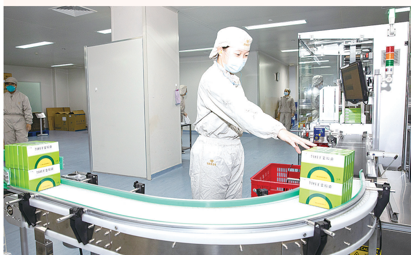
千金药业河西制剂车间妇科千金胶囊的自动包装线。受访企业供图
