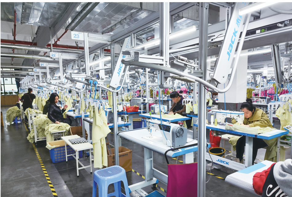
智能吊挂系统通过轨道方式将服装送向缝制车间。记者/杨凌凌 摄
