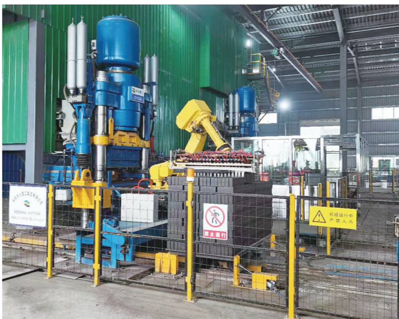
华新水泥株洲工业园新型机制环保砖生产线上的砖臂。
