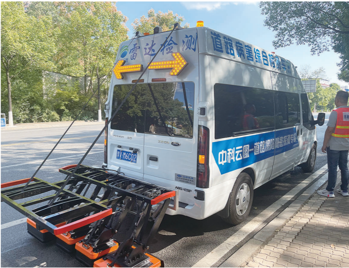
市政部门开始对道路地下空洞问题进行排查。 株洲日报·掌上株洲记者/伍靖雯 摄
