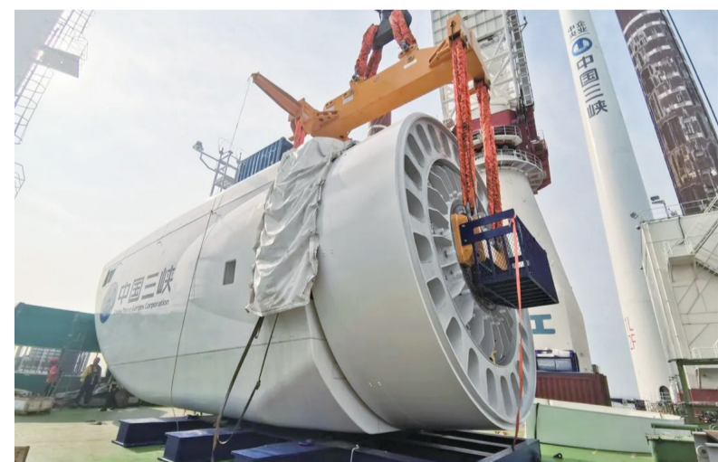
搭载中车株洲电机公司6.45MW直驱永磁风力发电机的机组。企业供图
