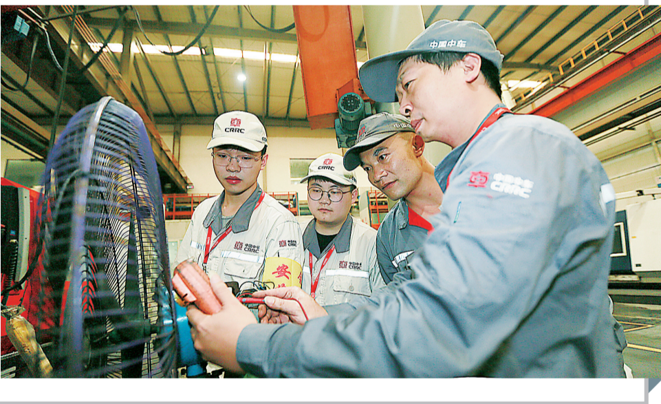
牵引电机车间维修班的师傅们正在对工业移动台扇进行接地保护检查。 株洲日报·掌上株洲通讯员/夏伟雄 摄
