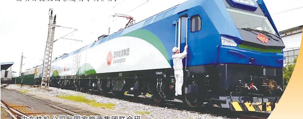
中车株机公司与国家能源集团联合研制的单机功率达28800千瓦的全球最大功率神24电力机车 (图片来源于网络)
