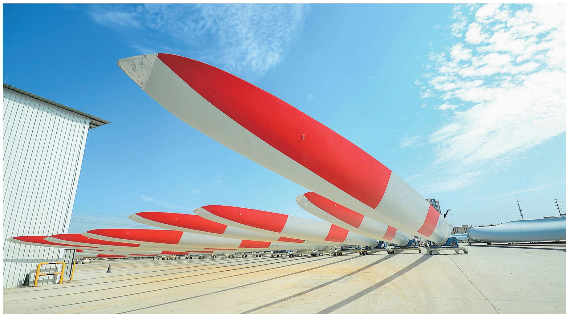
厂区整装待发的风电叶片。时代新材株洲动力谷厂生产各种型号的叶片,长的达到76米,短的也有59米,最重的达18吨。
