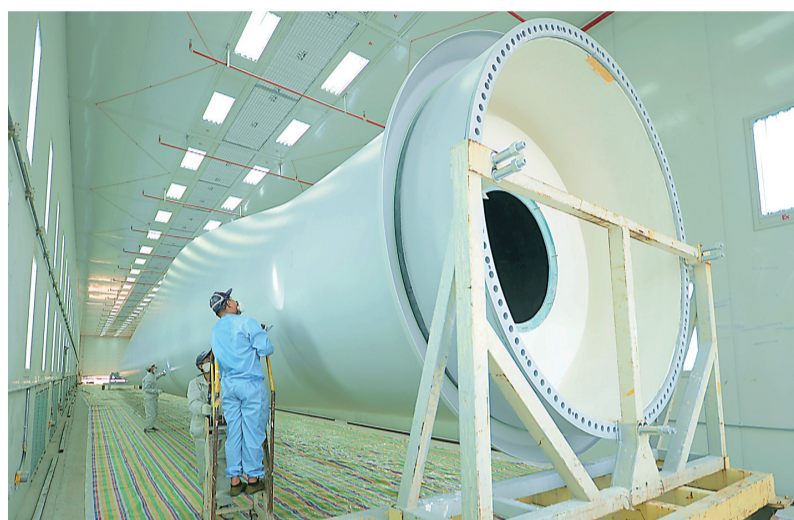
后处理车间的工人在油漆后检查叶片质量。一点小小的瑕疵也逃不过他们的火眼金睛。
