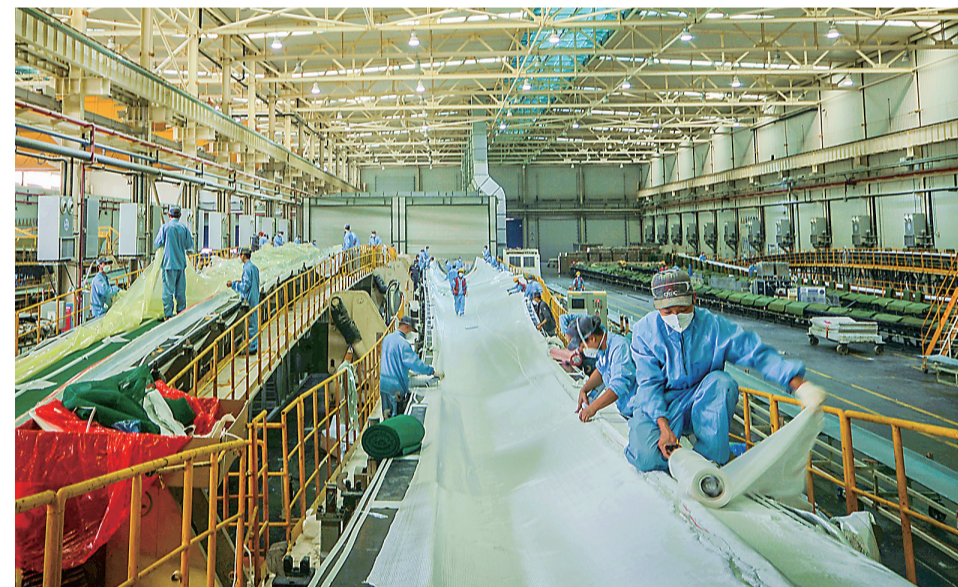
成型车间工人在铺层。制造一支叶片,需要铺设60多层不同的材料,然后才能灌胶成型。
