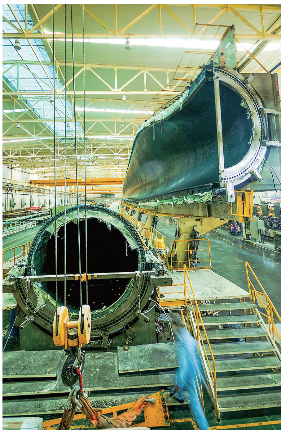
成型车间的工人在利用行车脱模。先把上模打开,然后吊运成型叶片至后处理车间精加工。
