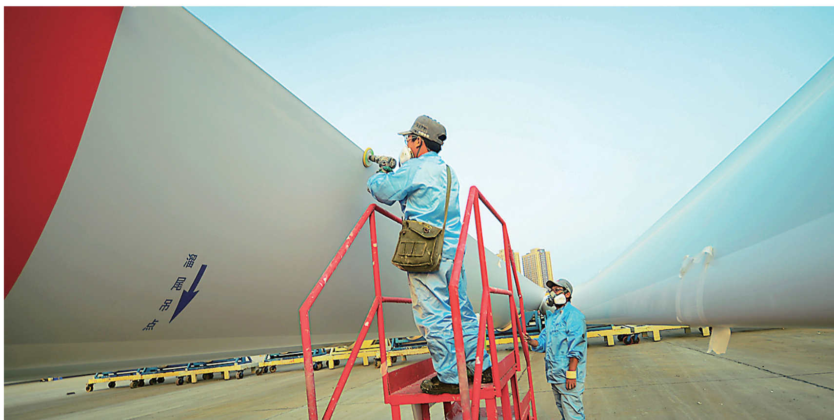
发运班的工人在作最后检查和精细打磨。力求叶片完美,以确保质量,满足客户的需求。
