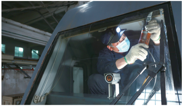
廖继斌正在内燃小辅修库用电动切胶机切机车车头玻璃内胶条。 通讯员/供图
