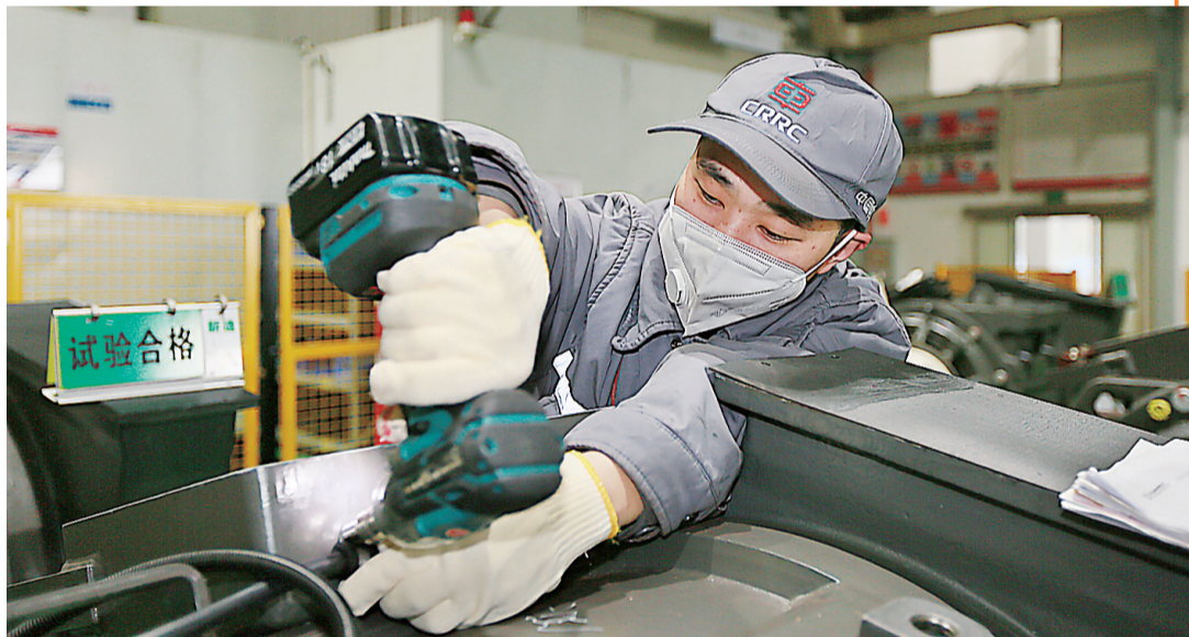
新年首月，中车株洲电机有限公司已完成30个新造牵引项目的生产，交出各种型号的牵引电机超过800台。“十三五”期间，中车株洲电机每年新造交付的牵引电机产品都在1万台以上，2020年更是新造交付了10847台牵引电机产品。图为中车株洲电机员工陈杰正在给一台新造大功率电力机车牵引电机安装传感装置。株洲日报记者 高晓燕 通讯员/夏伟雄 摄
