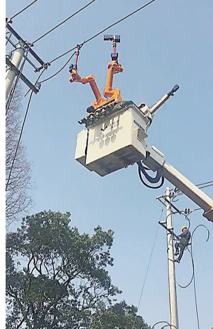
带电作业机器人在高压线上模拟作业。刘奎摄
