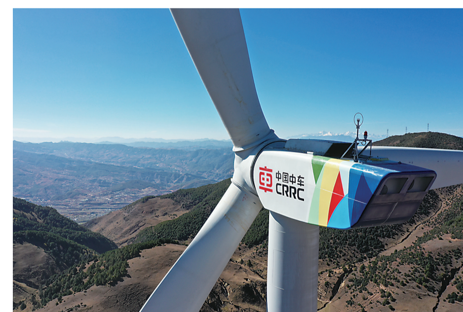
▲中车株洲所研发的国产陆上首台“箱变顶置”风电机组 受访企业供图
