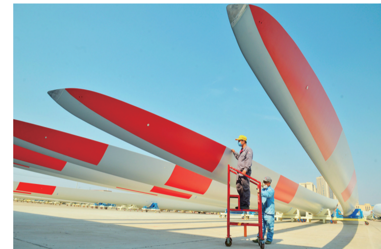
▲株洲时代新材料科技股份有限公司风电产品事业部,工作人员正在对风电叶片进行出厂前的检测 通讯员供图
