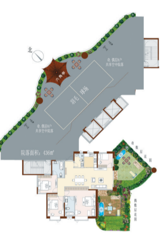
1#楼 B1/B2户型图 庭院房 4房2厅(2主卧) 建筑面积179.05㎡ 私家花园约45㎡ 共享院落约436㎡ (注:B2户型位于独栋层,通过门前走廊、电梯或楼梯,均可到达“共享院落”。) 本户型为:第四代住房的第二种建筑形式-空中园林住宅(即每户门前都有一座几百平方米的空中院落)。第四代住房的户型图,由三部分组成,即:门前空中合院+房子+私家院子。
