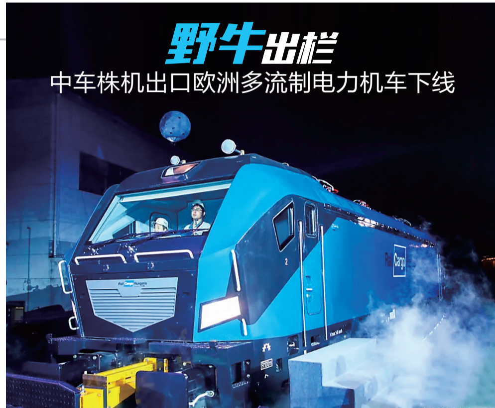
▲这台外形酷似“野牛”的多流制电力机车,最高运行时速140千米 受访企业供图
