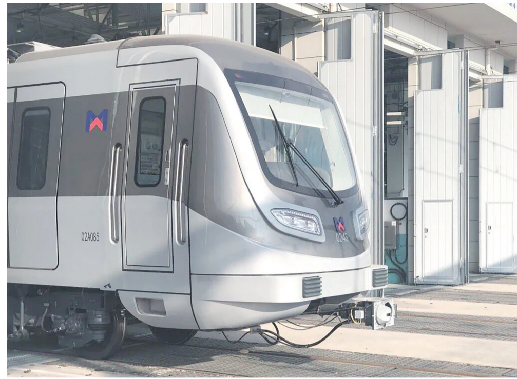
▲厦门地铁2号线永磁式电客车驶出车库。它的永磁同步牵引系统由时代电气制造 受访企业供图
