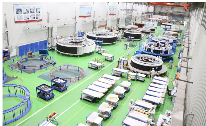
▲中车株洲电机公司永磁风力发电机生产现场 通讯员供图
