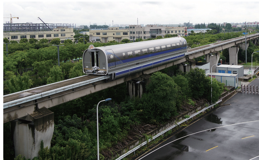
▲6月21日,时速600公里高速磁浮试验样车在磁浮试验线上试跑(无人机照片)
