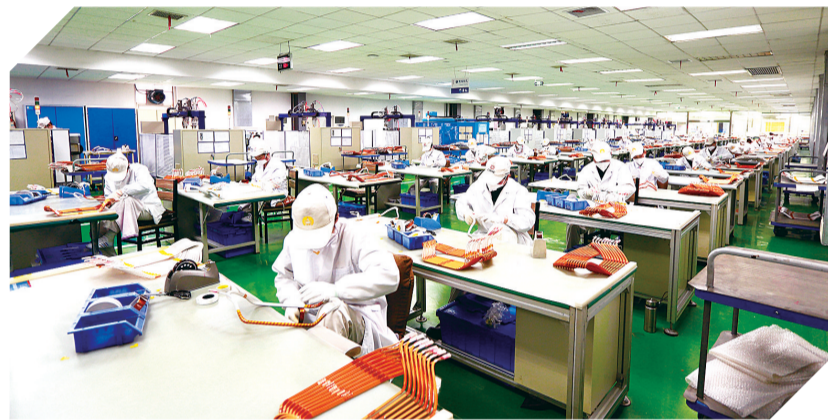
▲中车株洲电机牵引电机线圈包扎生产现场
