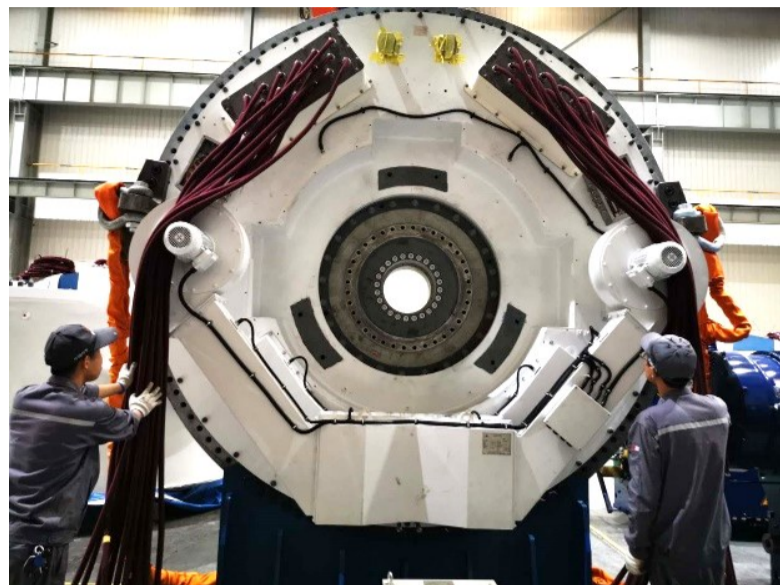
国内首台7MW海上半直驱永磁风力发电机完成组装 通讯员供图
