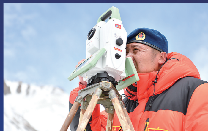
自然资源部第一大地测量队队员郭珠在使用全球仪对珠峰峰顶进行交会观测(5月27日报)。新华社记者 肖昊多吉 摄
