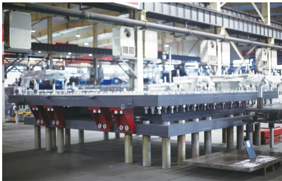
时代新材生产的“巨无霸”球型钢支座。受访企业 供图
