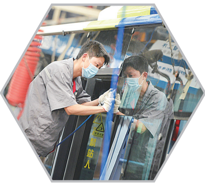
▲中车电动新能源客车整装车间里，青年工人康怀坤在安装客车的乘客门
