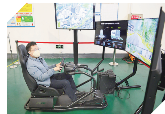
▲工程师肖涌坐在公司的远程操控台上控制户外作业车辆
