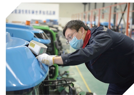
▲生产车间里,工人师傅在安装激光雷达。激光雷达主要用于检测车辆前方的障碍物
