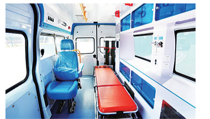
▲中车电动研发生产的负压式救护车内饰 受访单位供图
