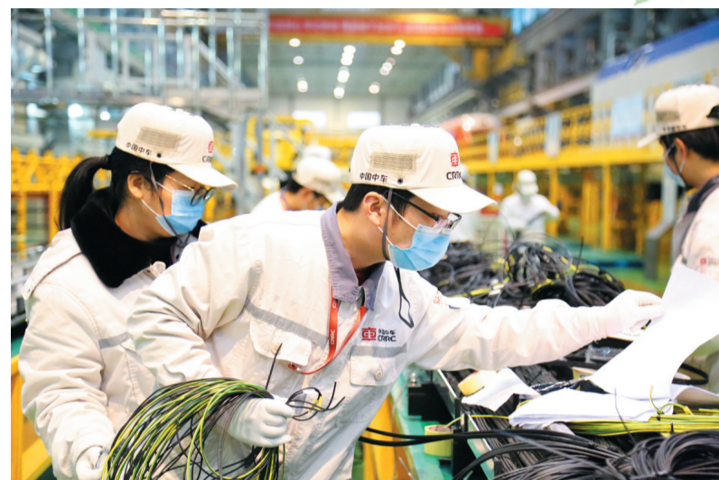
▲中车株洲电机事业部员工正在进行中央线槽预布线工作
