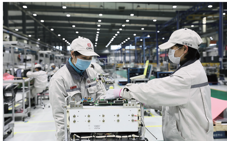
2月20日，株洲中车时代电气股份有限公司制造中心内，员工在对某机车变流器上的逆变模块进行布线组装。
