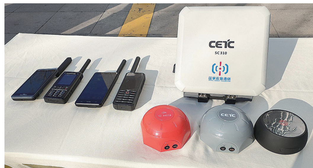
▲除了手持电话外,天通系统还包括车载终端、天通猫等多种终端类型
