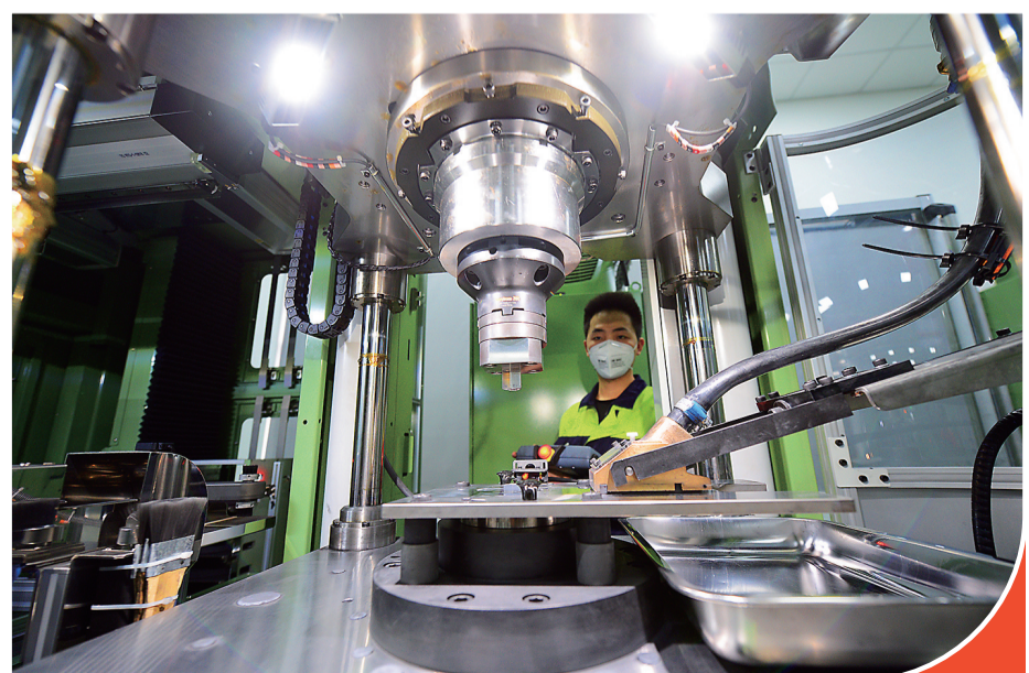
株洲华锐精密工具股份有限公司制造车间,自动化压机设备正在压制刀具毛坯。
