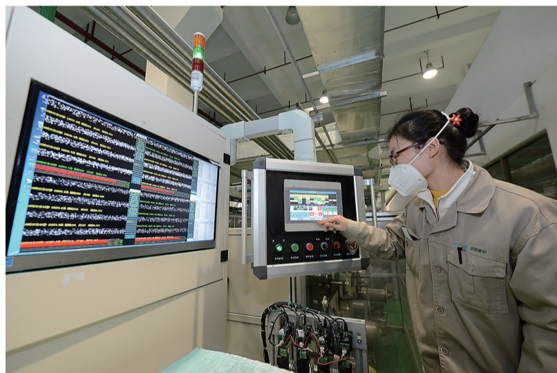
株洲岱勒新材料有限责任公司全封闭的生产车间,电镀生产线正在给细如发丝的金刚石线上镀金。
