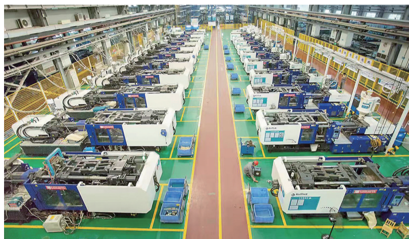
在时代新材的扣件基地注塑车间整齐划一的设备,今年升级后,可实现自动抓取、修边、装袋等流程。
