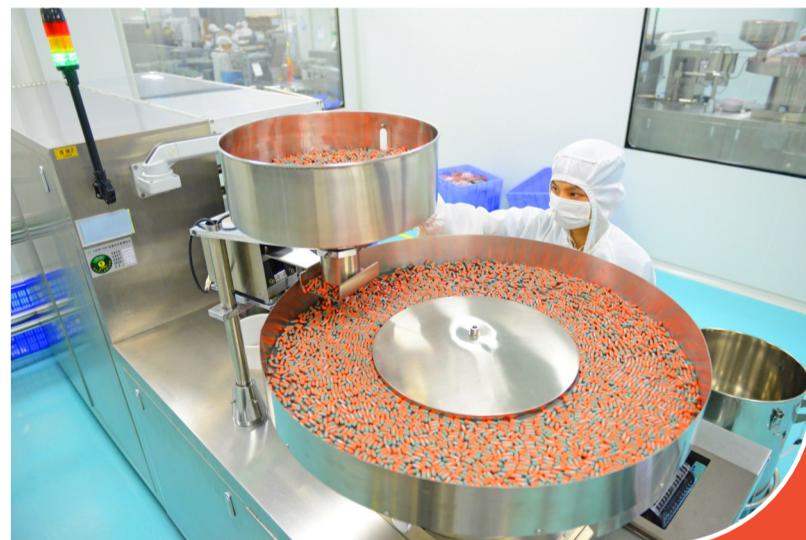
湖南千金湘江药业股份有限公司生产车间,DPH260H型高速泡罩包装机正在全自动运转。
