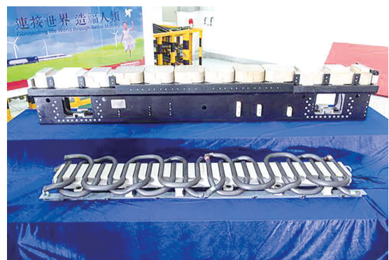
时速600公里高速磁浮列车长定子直线电机模块。
