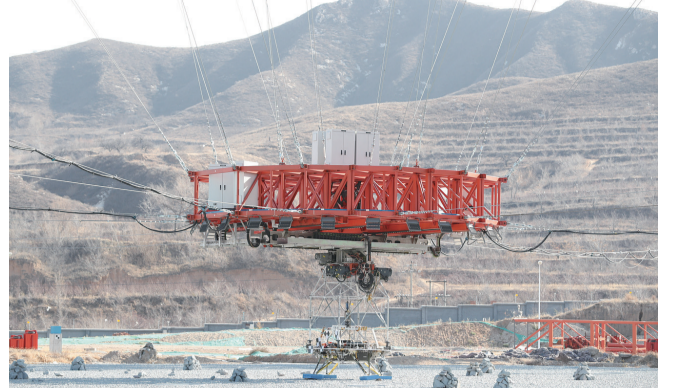
11月14日,我国首次火星探测任务着陆器悬停避障试验在位于河北省怀来县的天地外体着陆综合试验场圆满完成,此次试验是我国火星探测任务首次公开亮相,试验模拟了着陆器在火星环境下悬停、避障、缓速下降的过程,对其设计正确性进行了综合验证。图为当日拍摄的试验现场。 新华社记者 金立旺 摄
