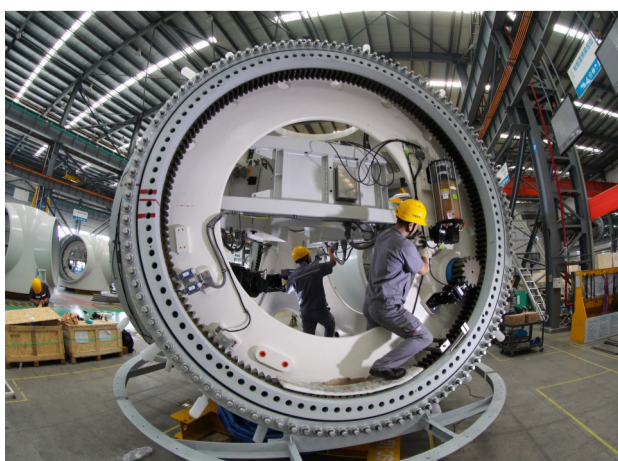
安装电气系统
