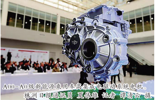
A00-A0级新能源乘用车高集成电驱系统电机。 株洲日报报道员 夏伟雄 魏奇 谭游云 摄
