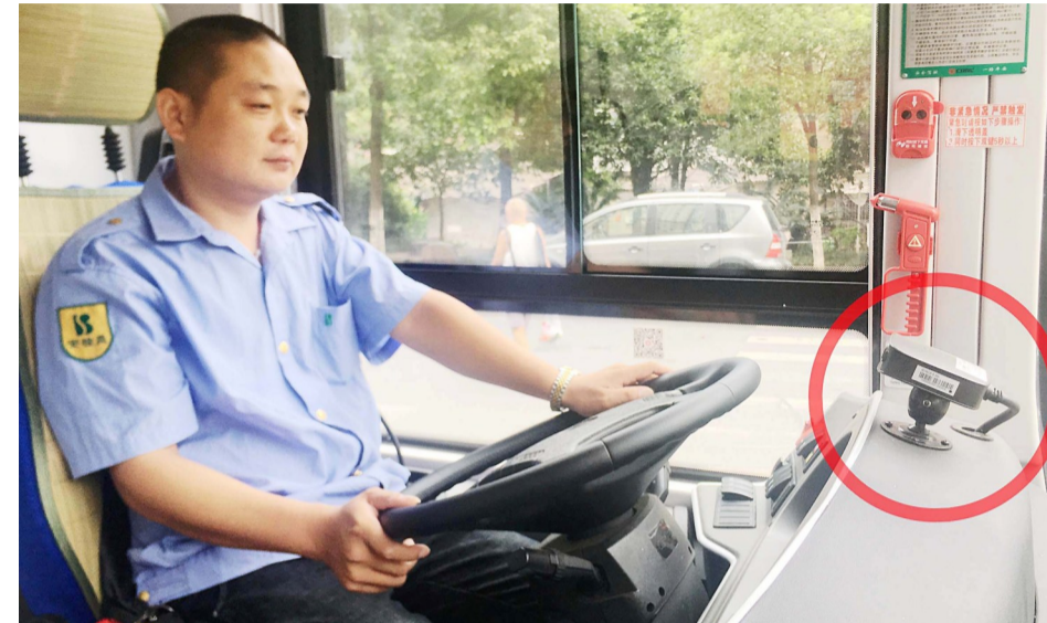
▲驾驶员操作台上安装了智能视频监控 记者 戴凇 摄
