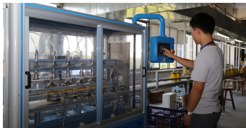
工作人员在使用全自动渗透检测机,检测陶瓷酒瓶。李兰薇 摄
