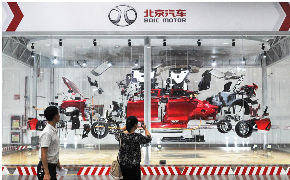
8月2日,在北汽株洲基地二工厂的总装车间内,前来参观的人正在一台北汽新能源EU5整车结构展示柜前拍照。这是目前国内第一个新能源整车结构展示工艺品,共展示了378个总成件、2862个下级零部件,使用了1000余米铜丝,穿过了1457个孔,固定了2322个卡箍。
