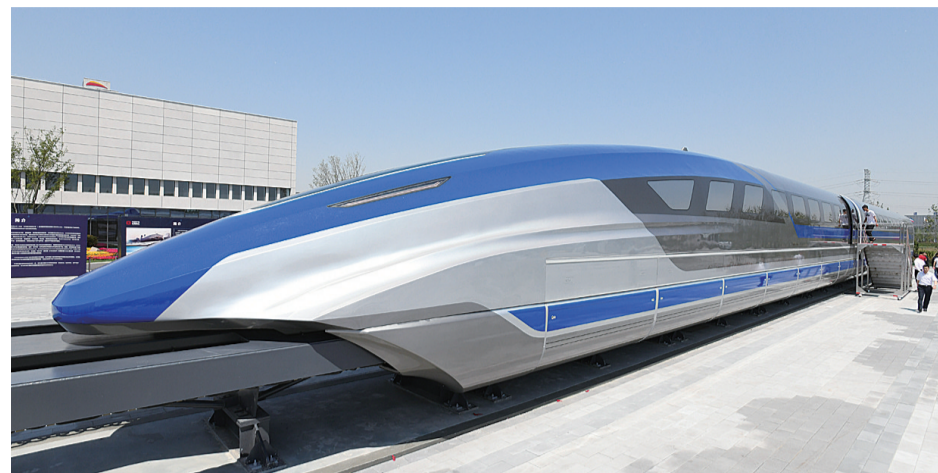
5月23日在青岛拍摄的我国时速600公里高速磁浮试验样车。新华社记者 李紫恒 摄
