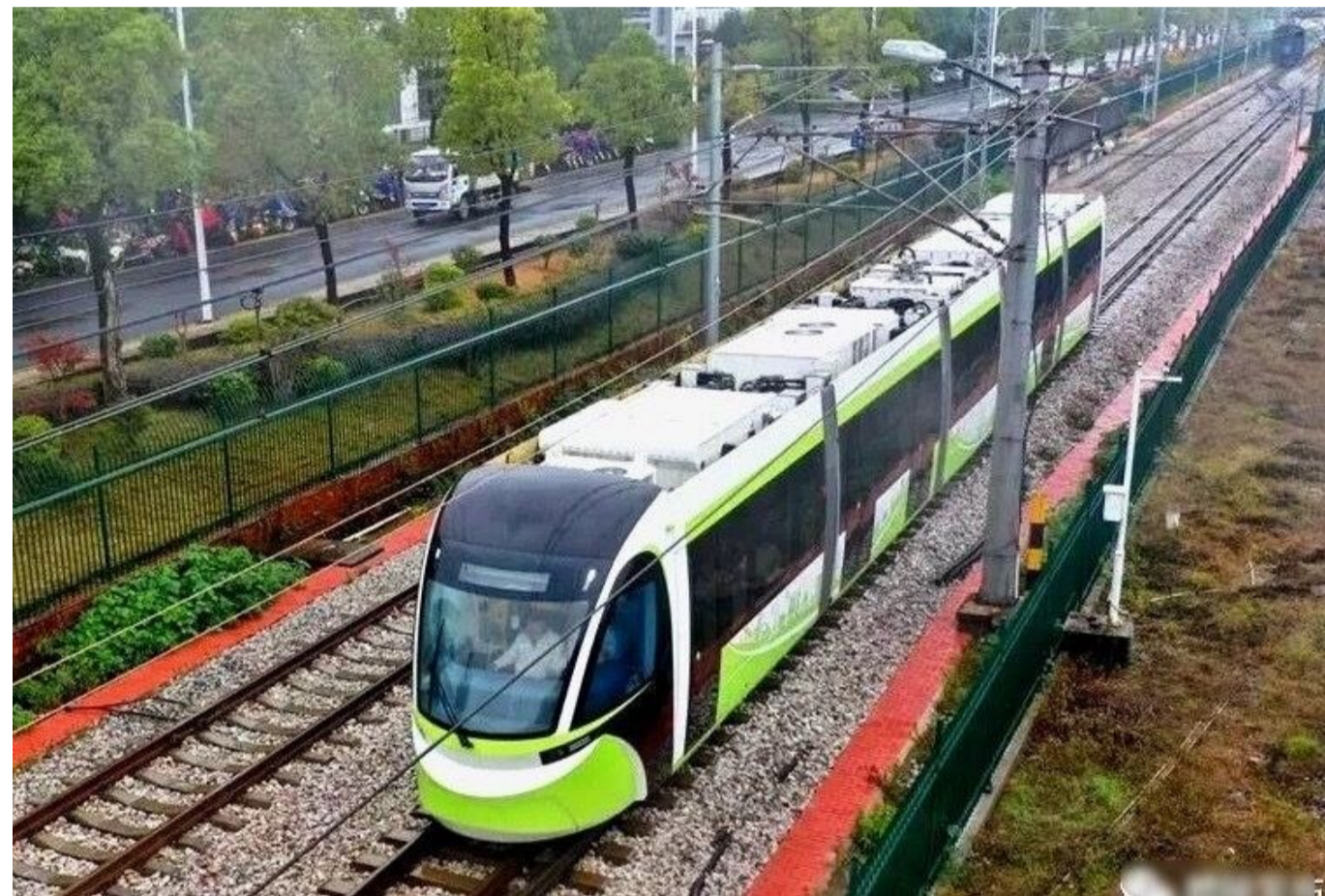
▲五模块储能式现代有轨电车在调试线上试验 通讯员供图
