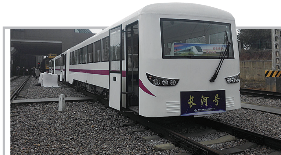
▲特种载人有轨电车转弯半径约为普通客车的四分之一
