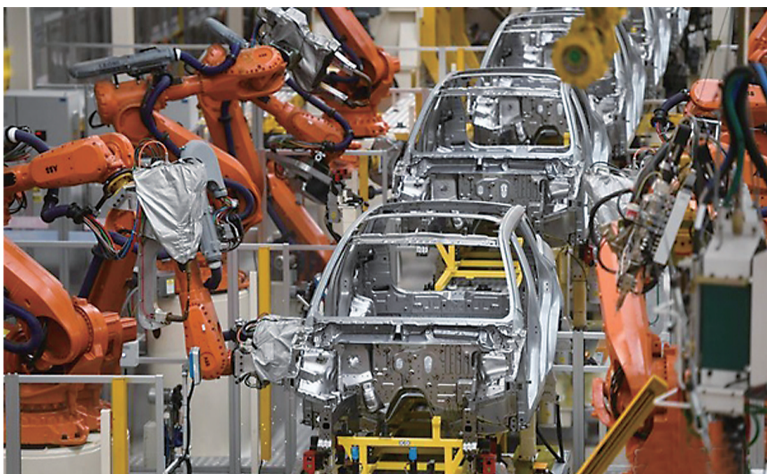
▲浙江宁波市北仑区吉利汽车春晓制造基地的自动化焊接线
