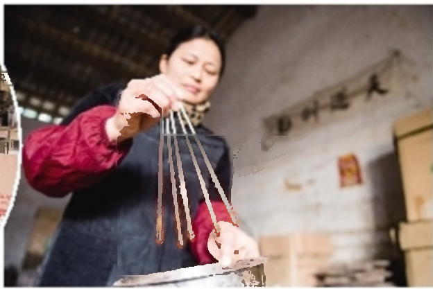
蜡烛制作要用竹签一层一层地包裹蜡,十分繁琐。
