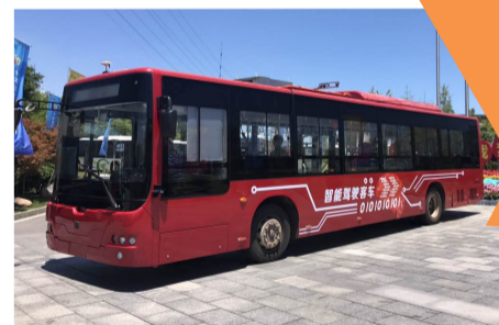
▲7月18日,中车电动自主研发的全球首款12米智能驾驶客车在我市公开进行“路考”,且自动完成了牵引、转向、变道等动作,最高时速40公里。这辆车周身共有8个传感器,采用夜视摄像头与毫米波雷达的“超融合”,可实现白天、夜晚的智能驾驶功能。
