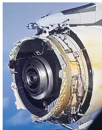
▲一台发动机的整流罩突然爆裂
