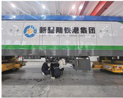
在联诚集团新产业事业部车间,一台老旧内燃机车即将完成新能源改造。
