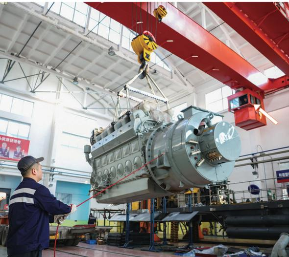
现场正在进行吊装柴油机作业(箭头位置为天车司机室)。 通讯员 供图
