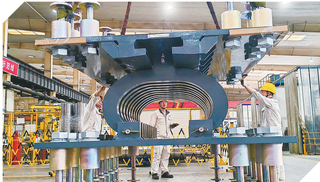
时代新材研制的超大Ω型横向钢阻尼器(资料图片)。
