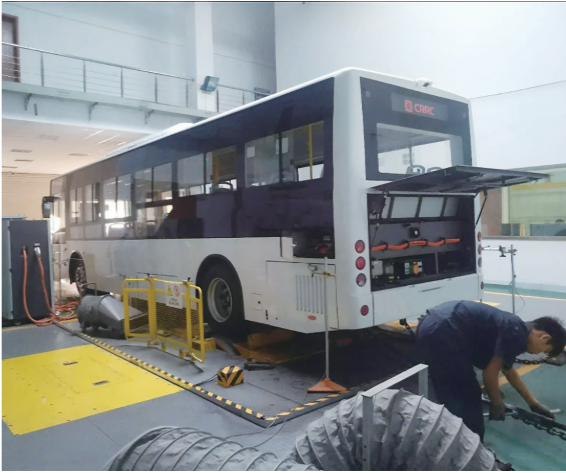
整车及零部件在试验台开展能耗测试。 企业供图
